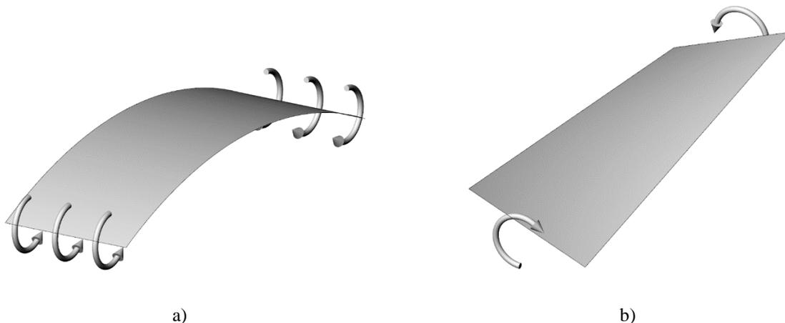
Fig. 1a) Cold bending and b) Cold warping
